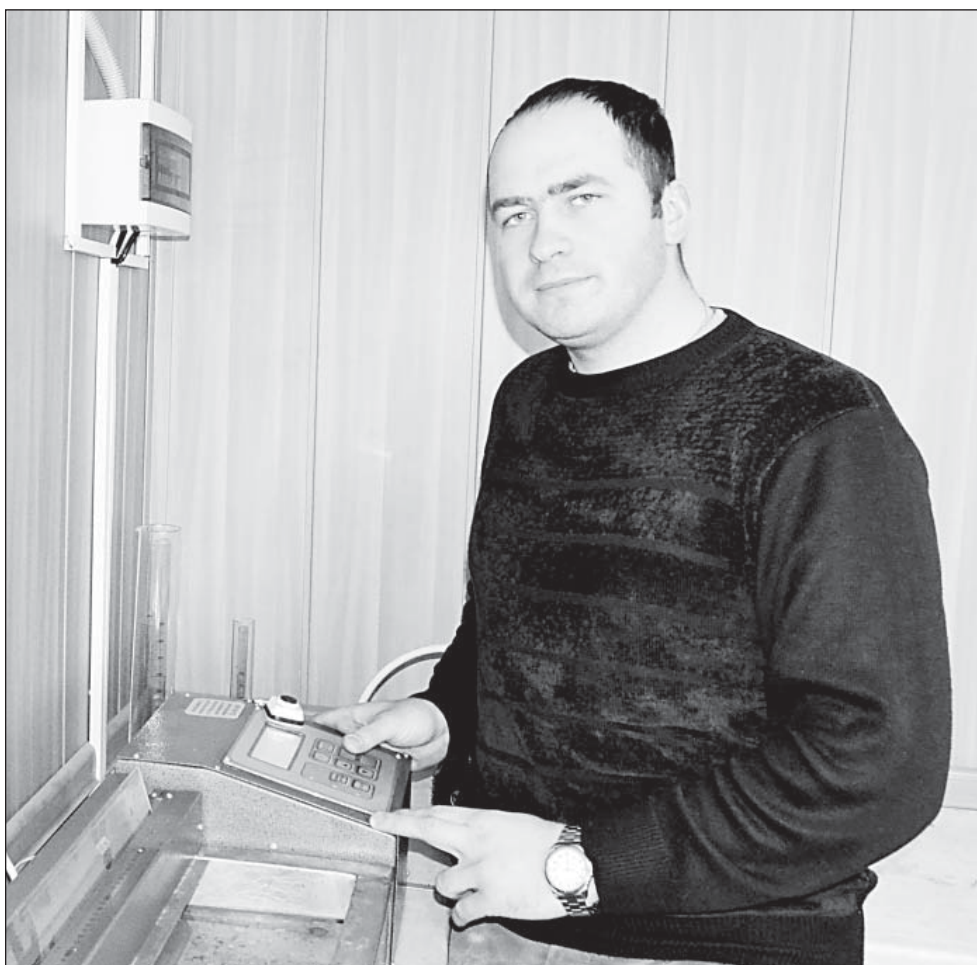
С помощью дуктилометра Евгений Друговской может оценить растяжимость битума
