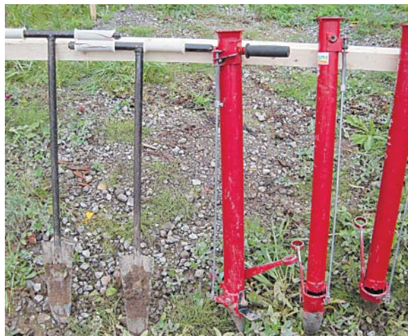
Приспособления для посадки саженцев: слева меч Колесова, справа посадочные трубы
